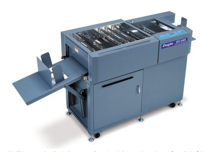
スリット(切削)、カット(断裁)、クリース(スシ`入れ)、ミシン目加工という総ての処理をワンパ<sup>°</sup>スで行う多機能型全自動断裁機です。レシ<sup>°</sup>ストレーション読み取り機能で、印刷位置のス<sup>°</sup>レを補正しながら毎回正確な位置に断裁します。また、パ<sup>°</sup>ーコート<sup>°</sup>を読み取ることにより全自動でシ<sup>°</sup>ョフ<sup>°</sup>のセットアップ<sup>°</sup>から仕上げまで一貫して全自動での対応が可能です。
